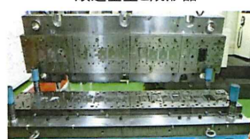
2.5インチサイズHDD基台部品の順送金型と成形品
